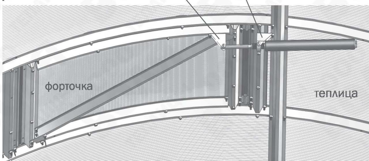
3. Закрепить толкатель в кронштейне К1, установленном на теплице, закрутив без усилия два винта в регулировочную гайку толкателя (см. рис.2).
